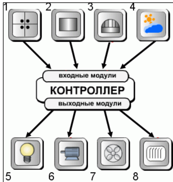
Рис. 1.10 – Принцип роботи централізованої системи [6]
