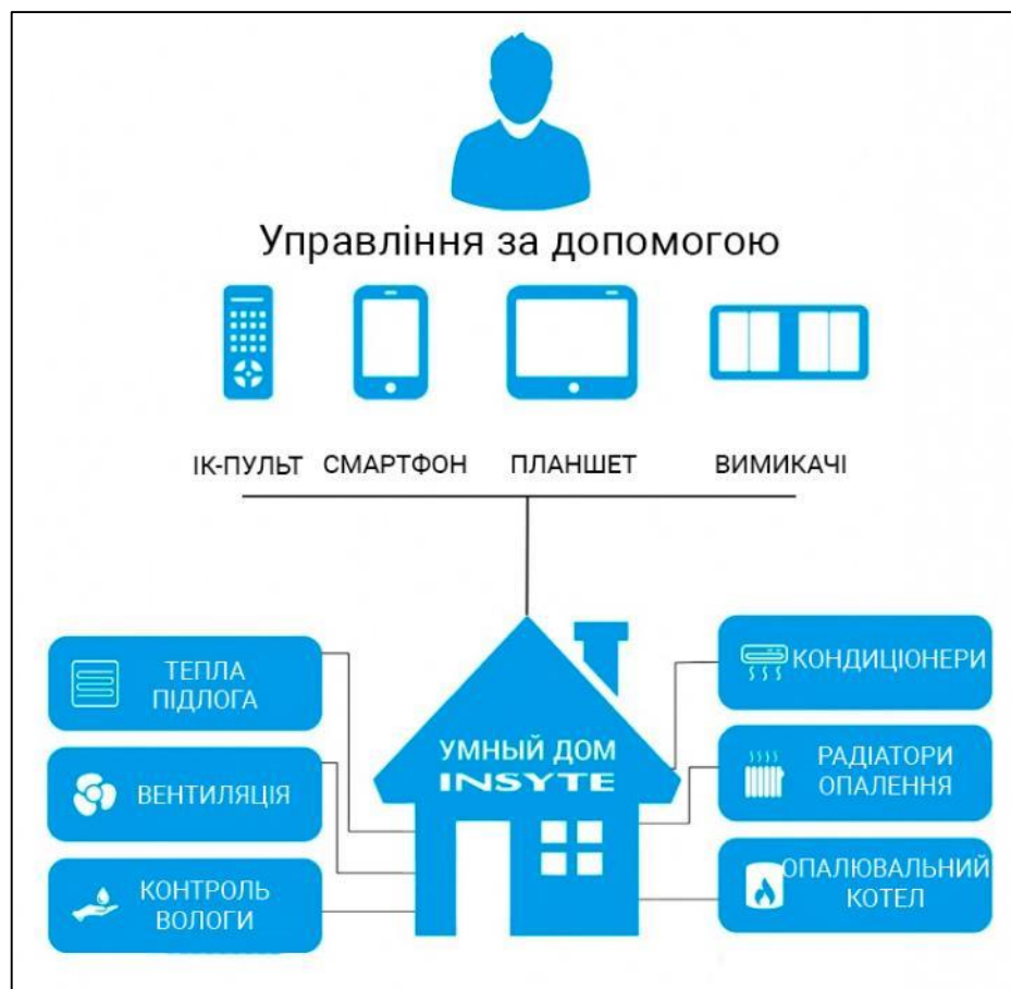
Рис. 1.6 – Схема управління кліматом
