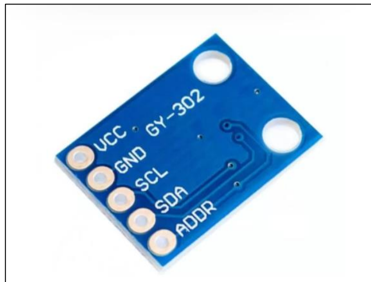
Рис. 2.29 – Виводи модуля GY-302
