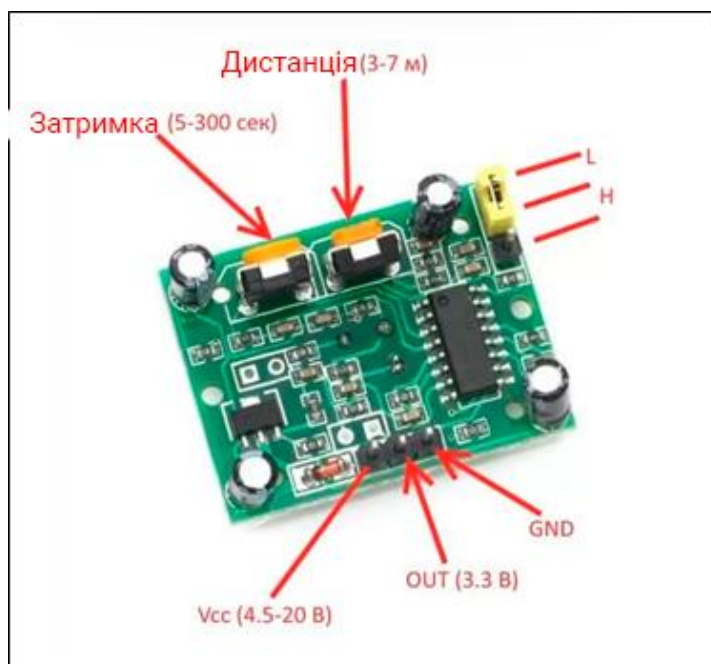
Рис. 2.27 – Призначення контактів та налаштування HC-SR501
