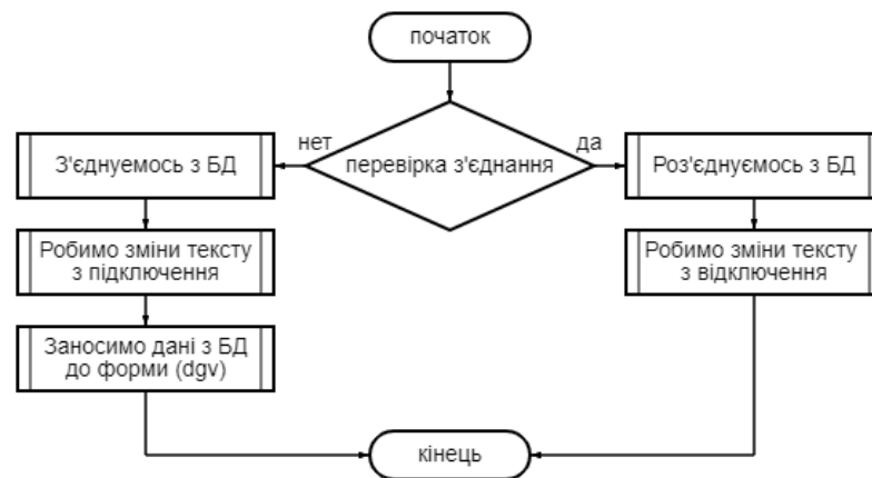
Рисунок 3.30 – Зображення алгоритму роботи методу підключення
