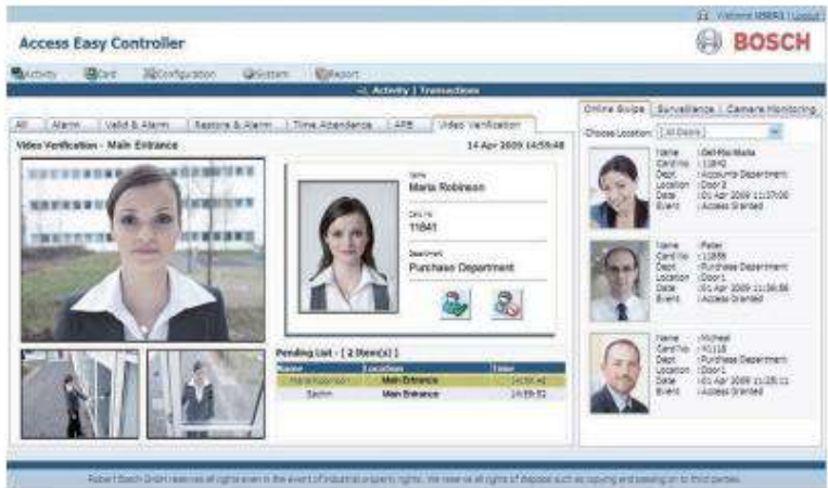
Рисунок 1.10 – Зображення панелі керування СКУД «Access Easy Controller 2.1 (AEC2.1)»
