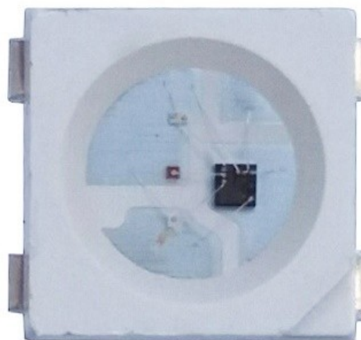
Рисунок 2.3 – Зовнішній вид LED світлодіоду WS 2812B у SMD корпусі
