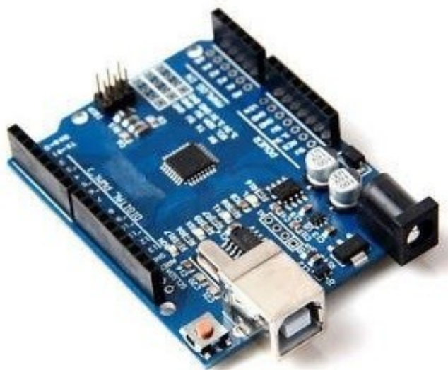
Рисунок 2.1 – Зовнішній вид плати Arduino Uno
