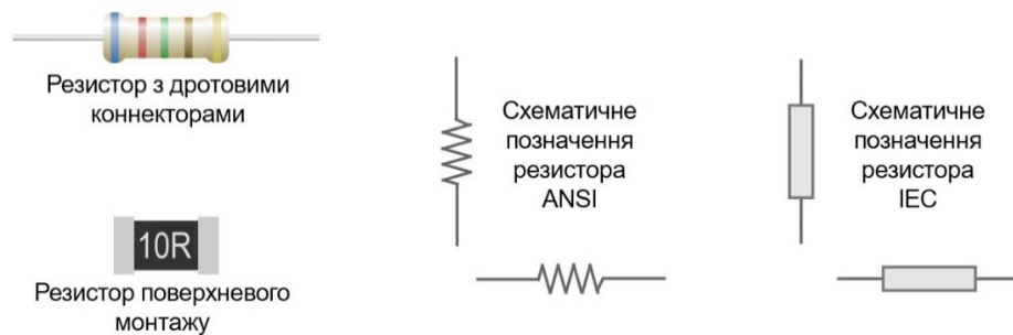
Рисунок 2.6 – Вигляд та схематичне зображення резисторів
