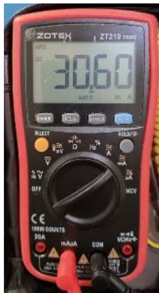
Рисунок 3.1. – Результати заміру струму через світлодіоди
