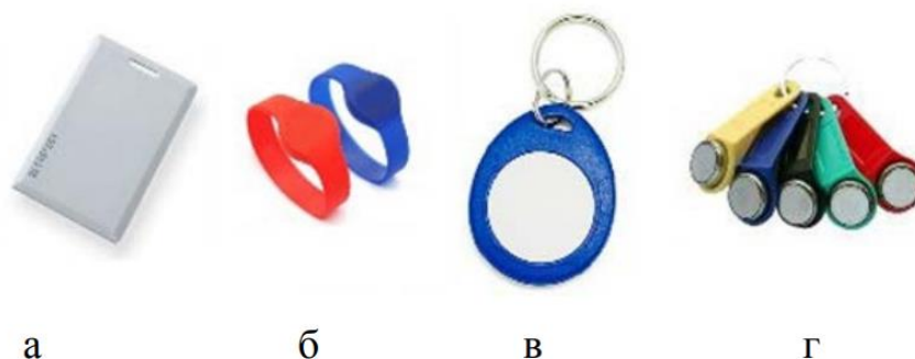
Рис. 1.2. - Типи електронних ідентифікаторів (а- картка, б – електронний браслет, в, г – брелки Touch Memory)
