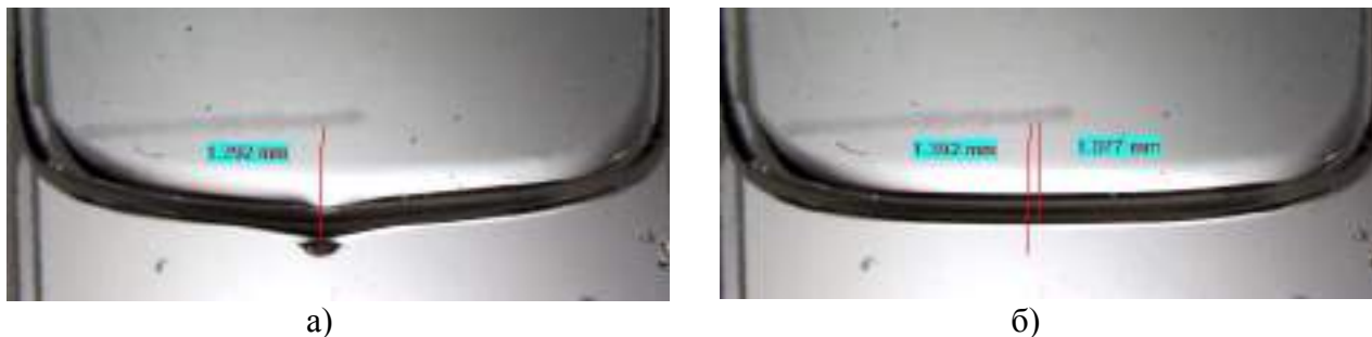
Рис.2 – Зображення профілів менісків води під дією повітряного струменя (а) і в спокійному стані (б)
